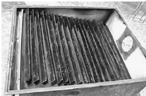
-a- Modification d'un distillateur avec la feuille enduite pliée, perforée et noire flottant au-dessus de la surface de l'eau.
