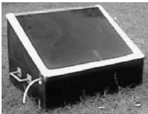
Figure 2-19 : Distillateur solaire réalisé (Source [MUH 2005]).
