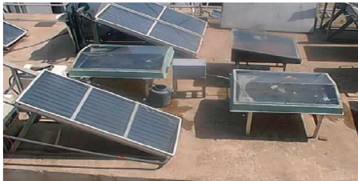
Figure 2-24 : Distillateur solaire couplé à un capteur (Source [CHE 1999]).
