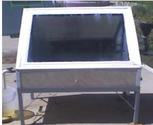
Figure 4-8 : Photo du distillateur solaire réalisé.
