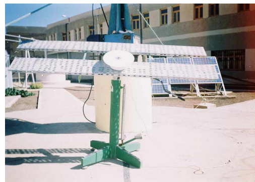
Figure 4-17: Pyranomètre fixé sur une table.
