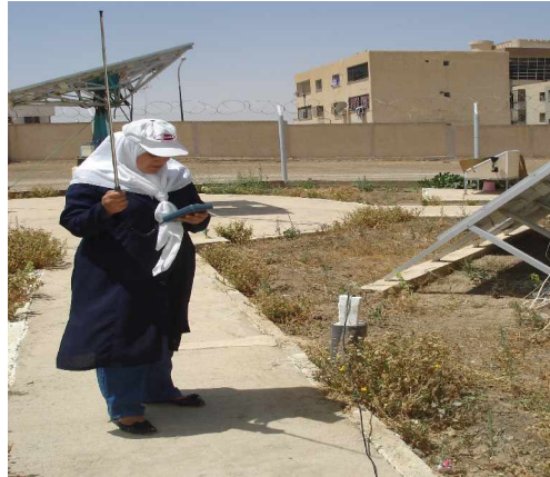
Figure 4-18: Mesure de la vitesse du vent à partir de AIRFLOW TA2.
