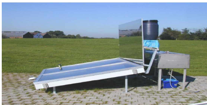
Figure 2-30 : Modèle de distillateur solaire à plusieurs étages (Source [KHE 2004]).
