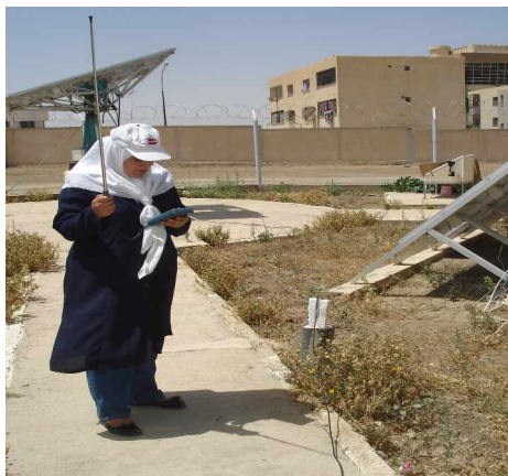
Figure 4-12: Mesure de la température ambiante à partir de AIRFLOW TA2.
