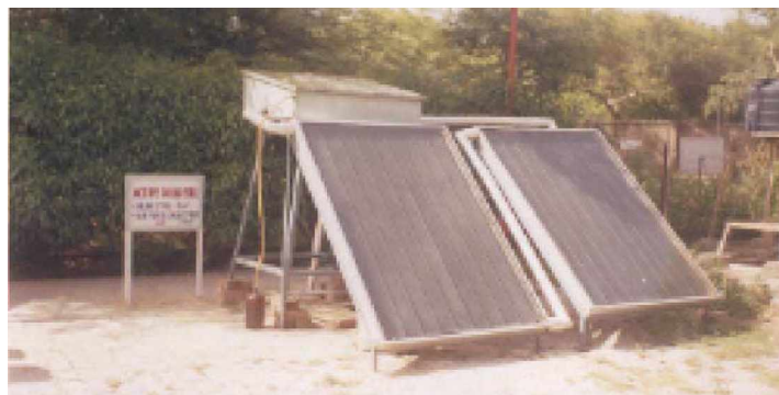
Figure 2-32 : Système de distillation solaire actif (Source [RAJ 2004]).
