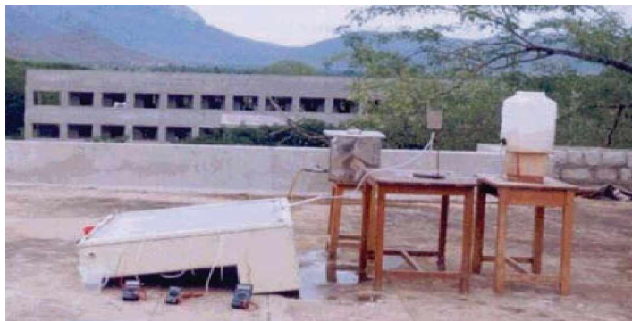
Figure 2-34 : Distillateur avec de l'eau circulant sur la couverture verrière (Source [JAN 2006]).
