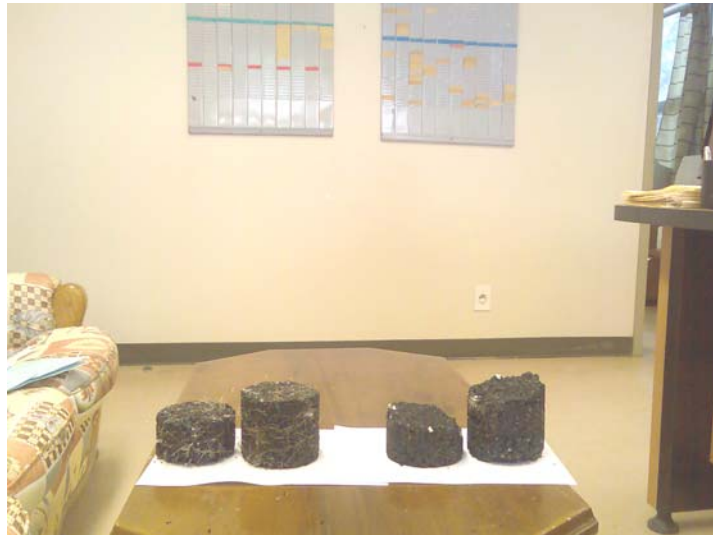
Figure VI. 4: Faciès de rupture des éprouvettes de bitume
