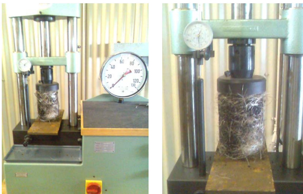
Figure VI. 2 : Machine d'essais Oehlpass et moyens de mesure et de contrôle
