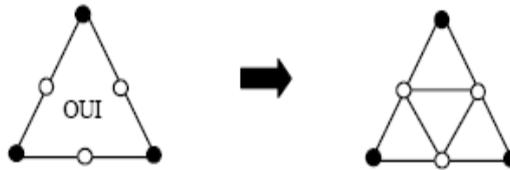
*Figure IV.8 Raffinement d'un triangle pour lequel le test de raffinement est positif, [44].*
