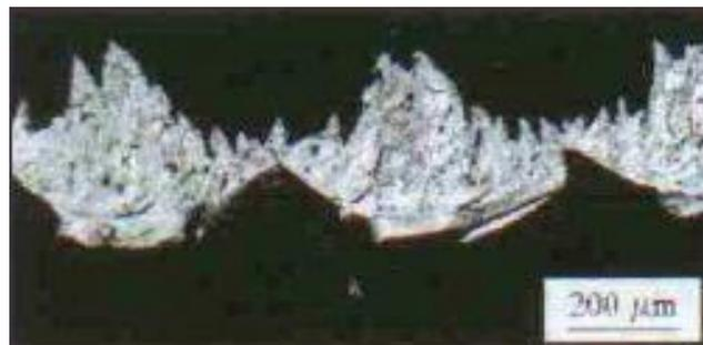
**Figure I.20 Copeau d'acier inoxydable de géométrie continue**
