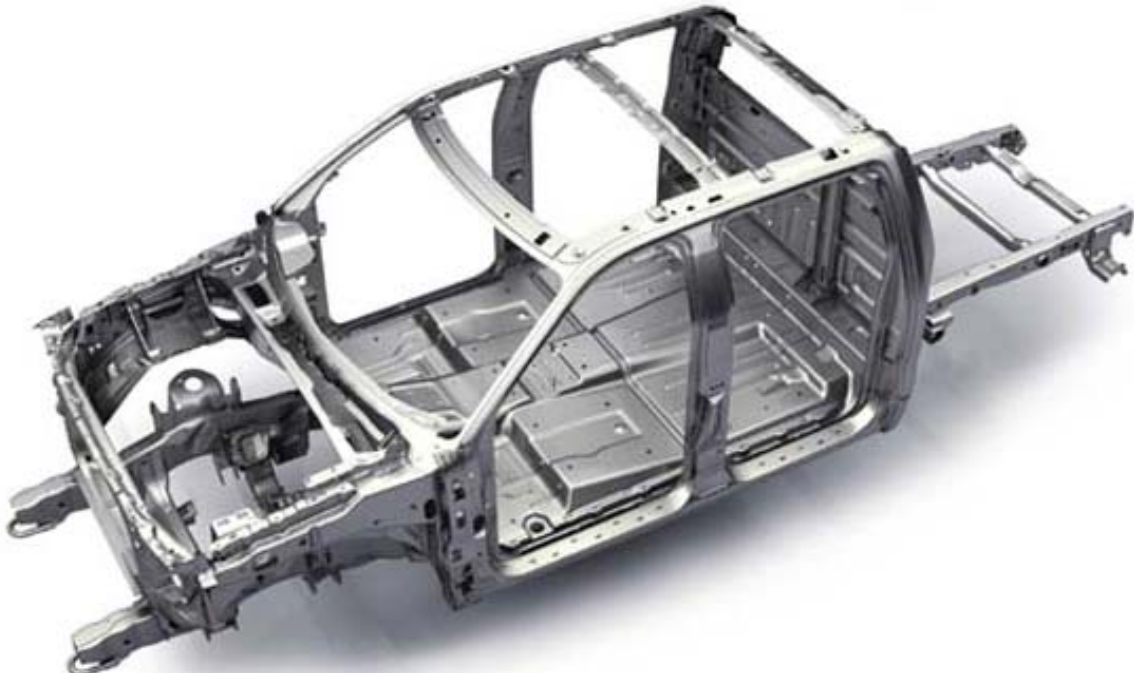
Fig V.1 La structure de base d'un véhicule « Ford f-150 »
