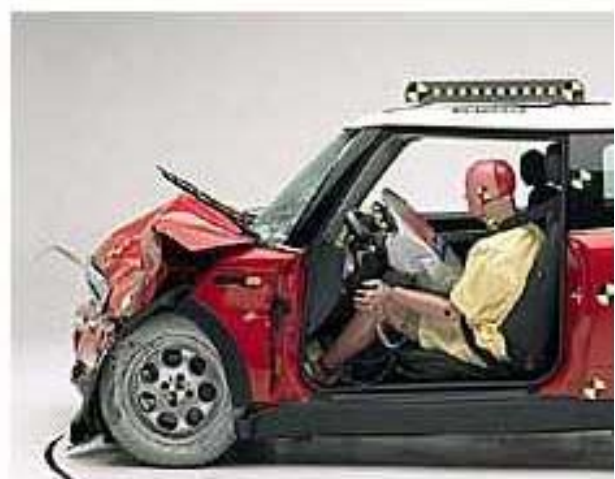
Fig.3 les résultats de Crash test à droite : mini cooper; à gauche: Ford f-150
