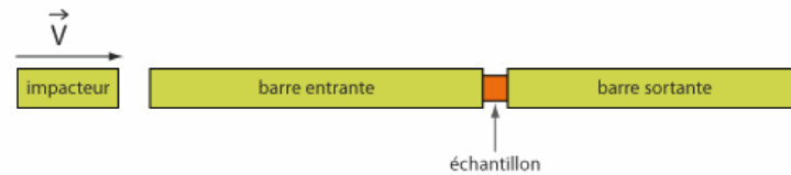
Fig III.11 les éléments principaux pour l'essai de barre Hopkinson
