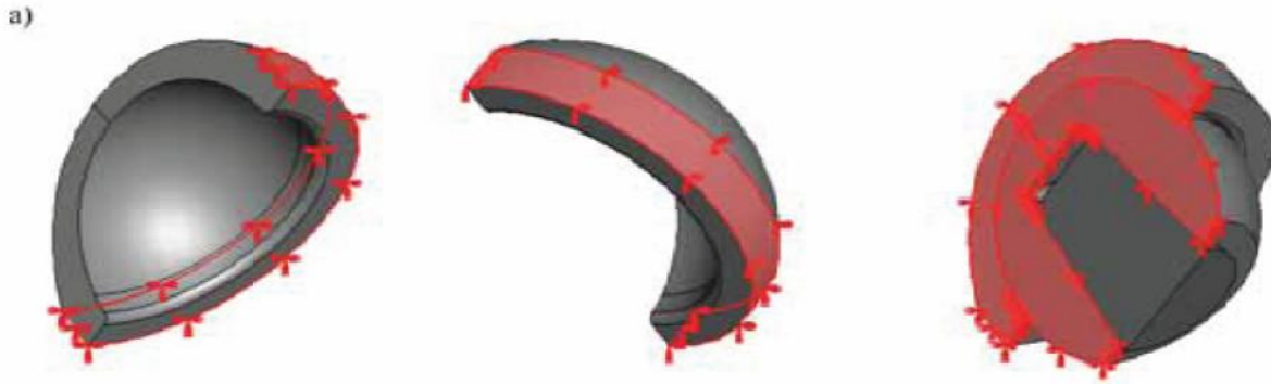
Figure 4.5 : Conditions aux limites appliquées au modèle. a) Condition d'encastrement de la cupule. Cette dernière est encadrée au niveau de sa périphérie, chaque ergot symbolise le blocage du mouvement en translation dans la direction considérée. b) Condition de symétrie par rapport au plan vertical.
