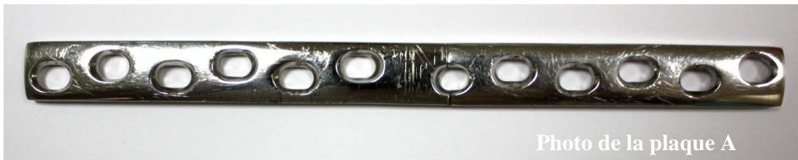
Figure V.1 Plaque fémorale A en acier inoxydable
