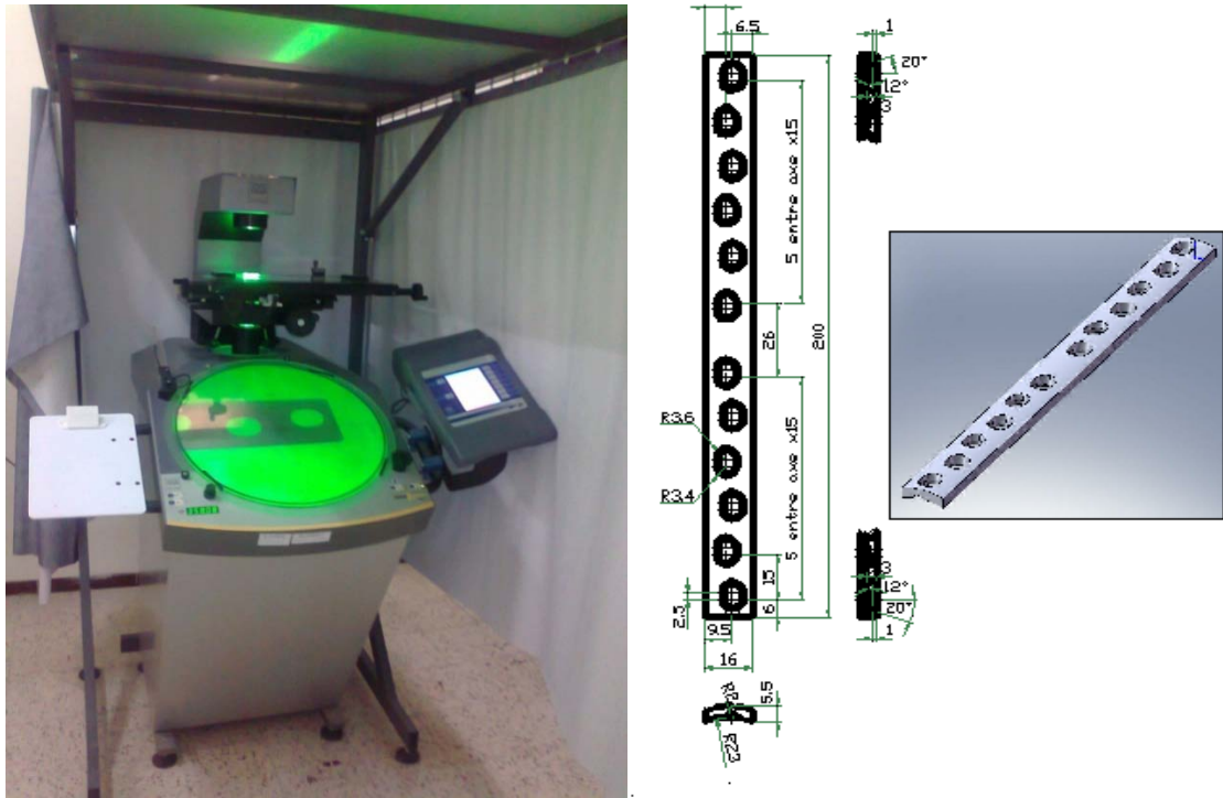
Figure V.4 Projecteur de profil (Tesa scope 500V) et la dimension de la plaque
