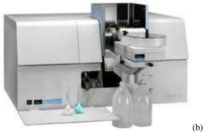
Figure I.1 Schéma de principe d'un spectromètre d'absorption atomique: (a) schéma de principe, (b) photo l'un spectromètre d'absorption atomique (SAA, avec l'aimable autorisation de PERKIN ELMER).
