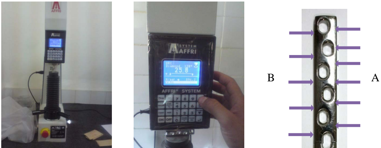
Figure V.6 :Duromètre digital (OMAGAFFRI modèle 250 MRS) et les faces latérale
