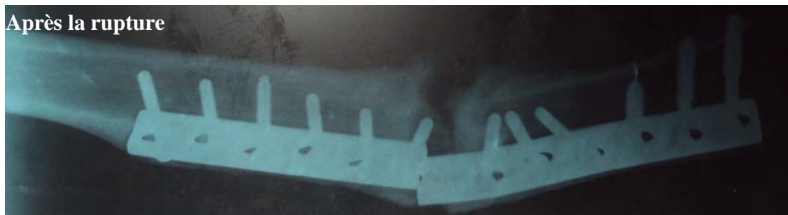
Figure V.2 Plaque fémorale B en acier inoxydable
