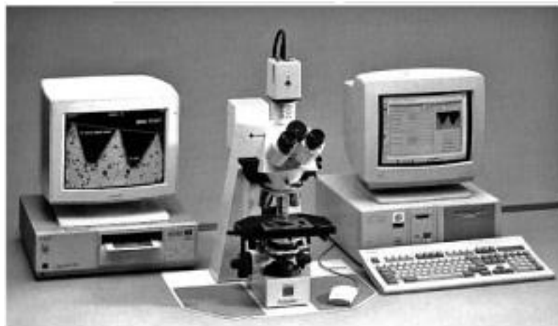
Figure I.8 Microscope optique équipé de caméra, moniteur et dispositif d'enregistrement numérique d'image (cliché Zeiss).
