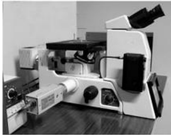
Figure I.6 Un épimicroscope optique inversé (cliché Nikon).
