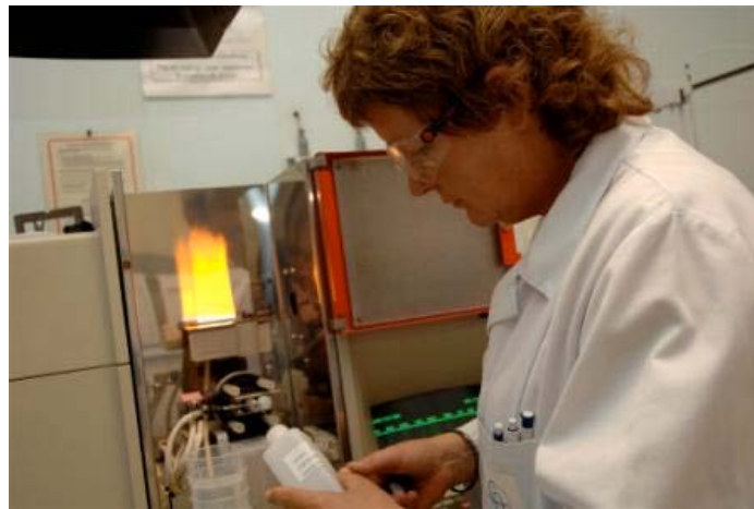
Figure I.2 Spectromètre d'absorption atomique (mode flamme) : A analyst 800 (PERKIN ELMER)
