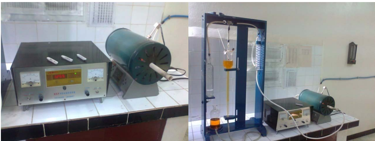
Figure V.16 Carbomètre à four tubulaire
