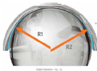
Figure 6 : Clearance entre tête fémorale et la cupule (Ch. Delaunay ; J. haussel)
