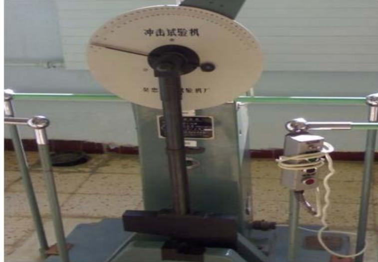
**Figure IV-2:** Dispositif de mesure de la résilience
