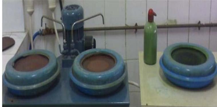
**Figure IV-5:** disque de polissage manuel
