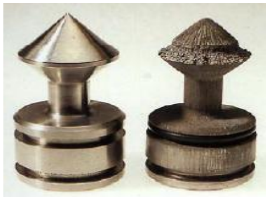
Figure I.6 : Corrosion-érosion due à de fortes vitesses de circulation du fluide corrosif (pointeau de vanne en alliage nickel-cuivre).
