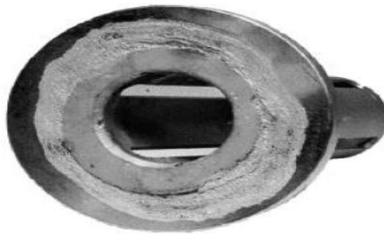
Figure I.9 : Corrosion par crevasse sous un joint
