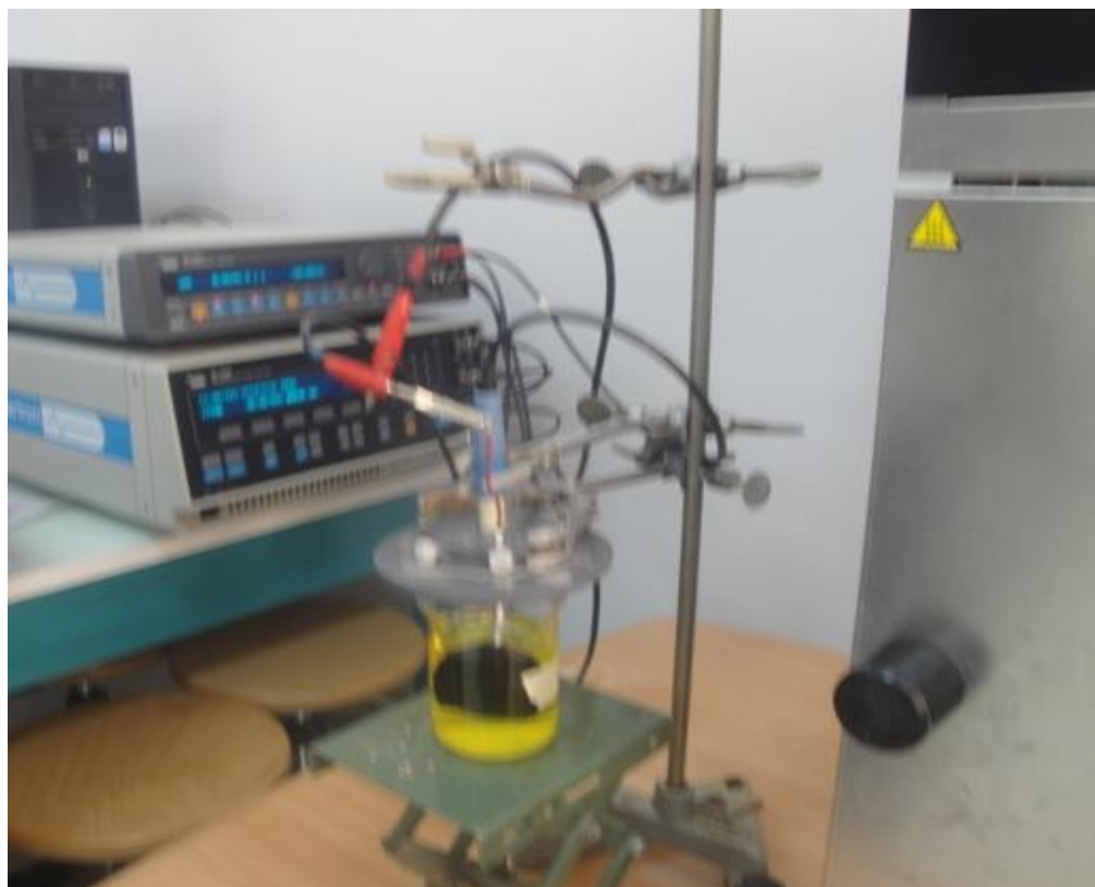
Fig.III.4. Photographie du dispositif de mesures électrochimiques.
