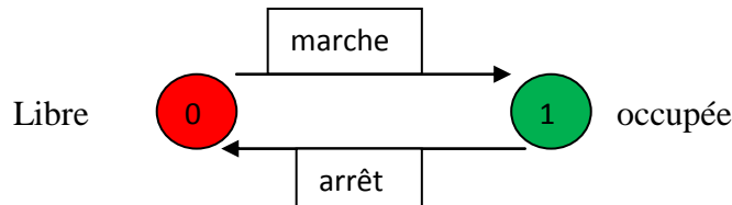
Fig 4.7 model d'automate fini de ressource sans défaillance.
