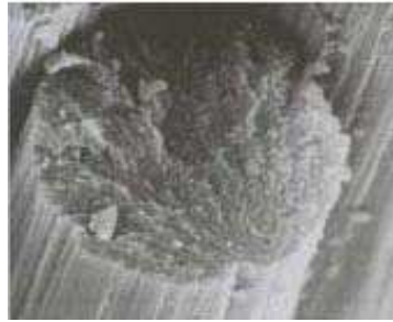
Figure II.14. Fibre de carbone constituée de plusieurs centaines de filaments [25].
