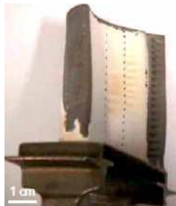
Figure. I.30. disparition de la couche de céramique par érosion.
