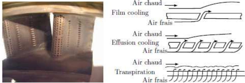
Figure. 1.25. Refroidissement par film [12]
