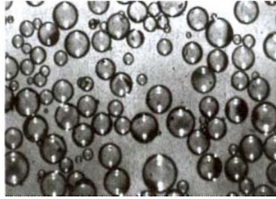
Figure 1.16. Microsphères de verre observées par microscopie optique.
