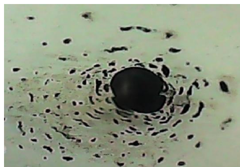
Fig. V.51(d) Etat de surface (nettoyée) après polarisation dans 00 nmole/g H_2O_2 , 00h immersion, T 37°C (X400).
