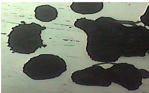
Fig. V.50(e). Échantillon Re-poli après polarisation, 96h immersion dans 100nmoles/g H_2O_2 , T 37°C (X200)
