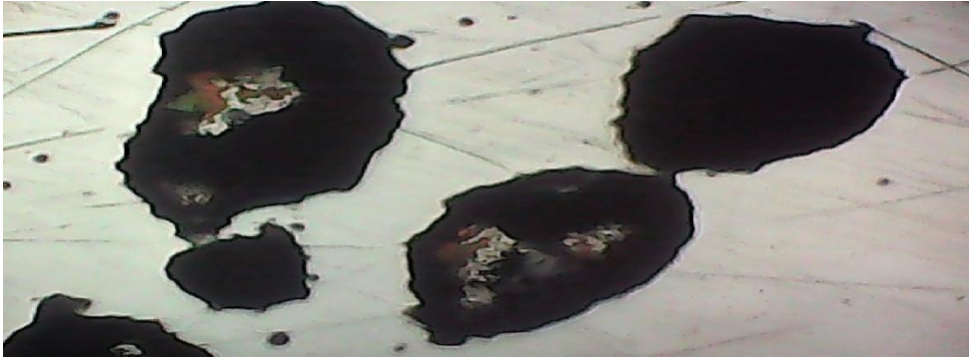
Fig. V.61. Micrographies des piqûres après nettoyage de la surface et repolissage (SIC 2400).
