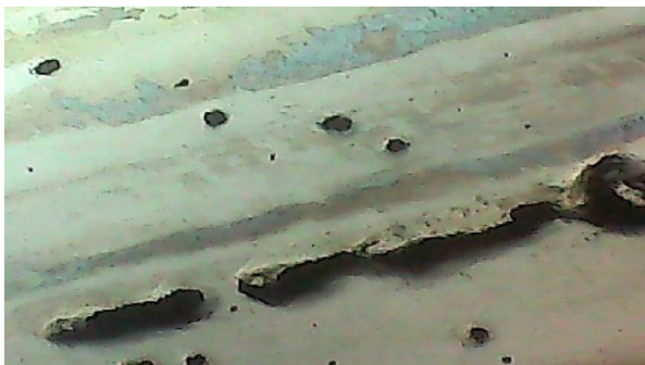
Fig. V.50(c) Alignement des piqures d'un échantillon polarisé dans 2 nmole/g H_2O_2 , immersion 96h, T 37°C (X 50)
