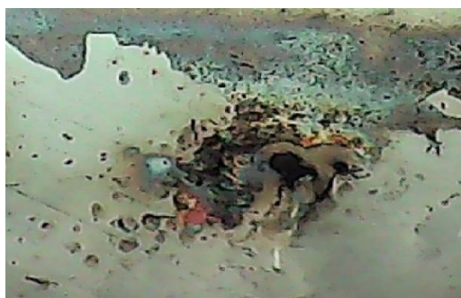
Fig. V.51(c). Etat de surface après polarisation dans 100 nmole/g H_2O_2 00h immersion, T 37°C (X200)
