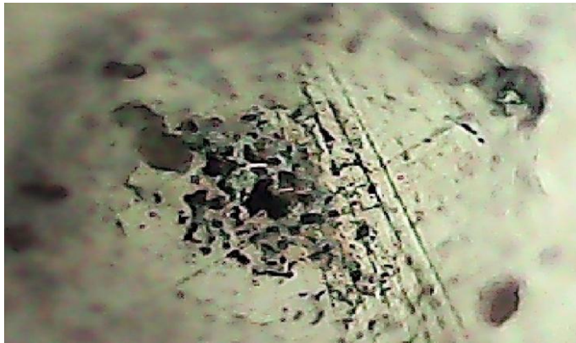
Fig. V.63. Détail d'une piqûre sur l'acier 304, Immersion immédiate, 9 g/l NaCl, 0.149 mmole (25 \mu l) H_2SO_4 .
