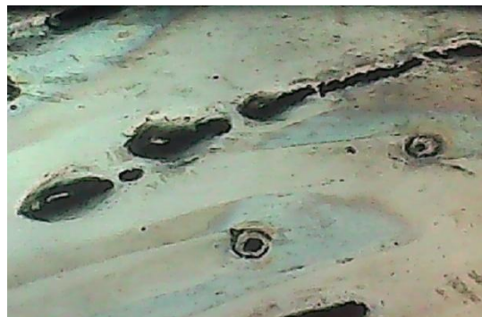
Fig. V.50(b). Alignement des pics d'un échantillon traité, polarisé dans 02 nmole/g \text{H}_2\text{O}_2 , T 37°C (X50)
