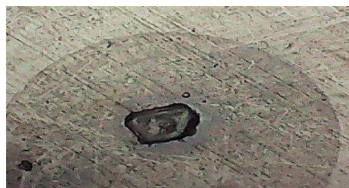
Fig. V.56. Micrographie de polarisation de l'acier 304 dans l'eau distillée avec 9g/l NaCl, 00h immersion à Température ambiante.
