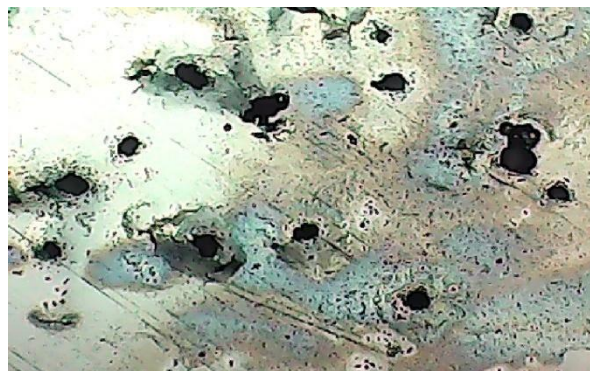
Fig. V.50(f) Piqures d'un échantillon polarisé dans 4 nmole/g H_2O_2 immersion 96h, T 37°C (X 50)
