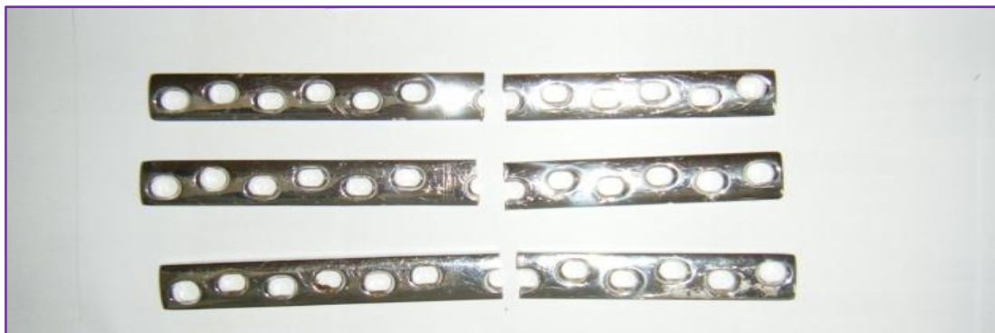
Fig. IV.1 : Implants fracturés après implantation
