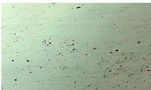
Fig. V.55. Micrographie de potentiel libre de l'acier 304 dans l'eau distillée avec 12,25 \mu l de H_2O_2
