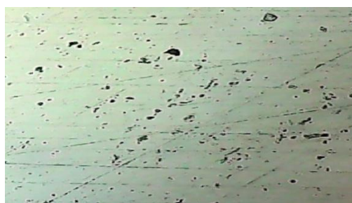
Fig. V.55. Micrographie de potentiel libre de l'acier 304 dans l'eau distillée avec 12,25 \mu l de H_2O_2
