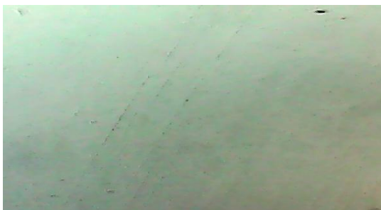
Fig. V.53. Micrographie de l'acier 316L après les tests potentiostatiques dans de l'eau distillée + 12,25 µl H 2 O 2 .
