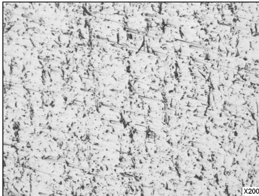
Fig. IV.18 : Micrographie optique de l'acier 304 (X500)
