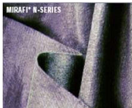
Figure 1-4 : Type d'assemblage des fibres (non tissé)
