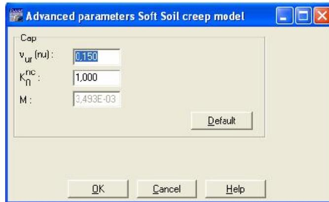
**Figure 5.24** Fenêtre des paramètres avancés du SSCM
