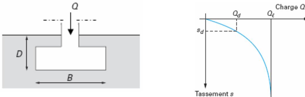
**Figure 3.4** Courbe chargement-tassement d'une fondation superficielle
