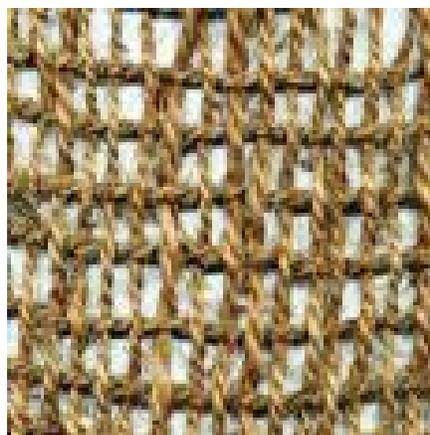
**Figure 2.3** Exemple de géotextile tricoté
