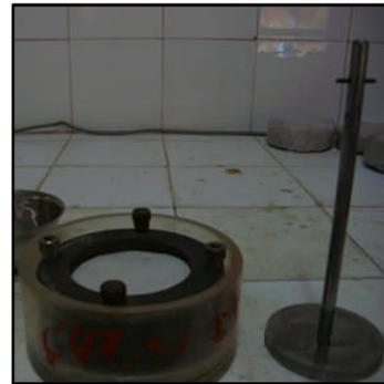
2- Mise en place dans la cellule œdométrique.
