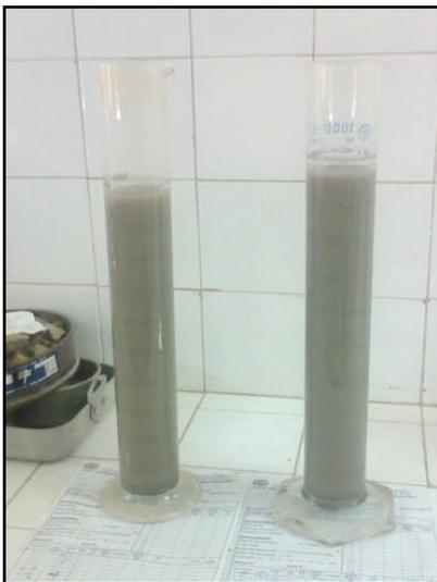
*Figure 3-2 : Eprouvettes de 1L pour l'essai de sédimentation.*
