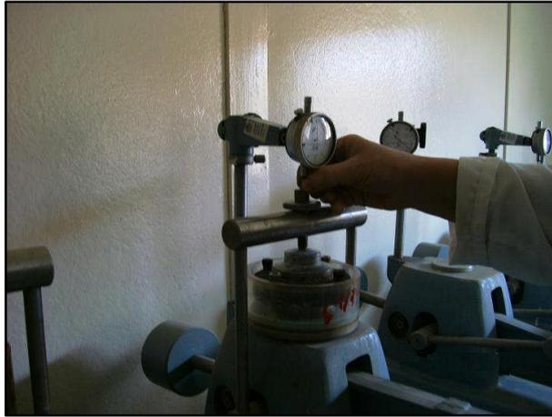
Figure 3-20 : Mise en place de la cellule œdométrique dans le bâti.
