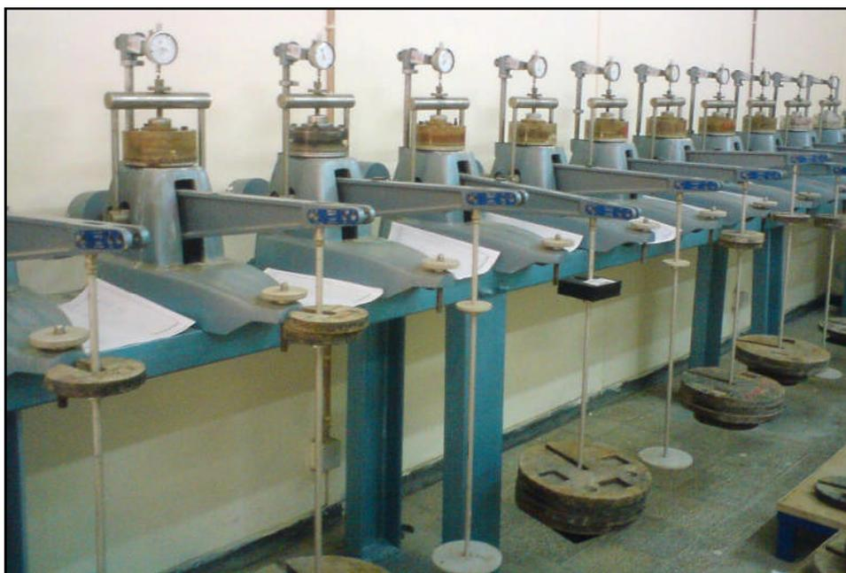
Figure 3-17 : Vue d'ensemble de l'œdomètre « LNHC Batna ».
