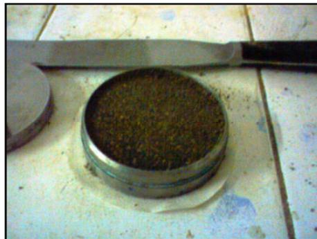
Figure 3-15 : La bague annulaire contenant l'échantillon du sol.
