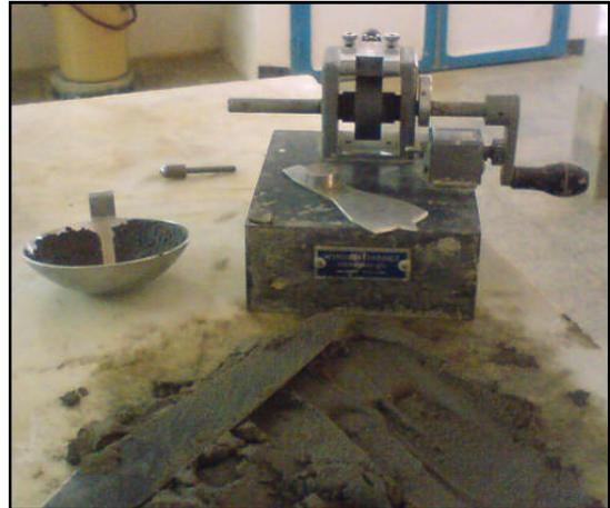
Figure 3-8 : Appareillage spécifique pour la limite de liquidité.
