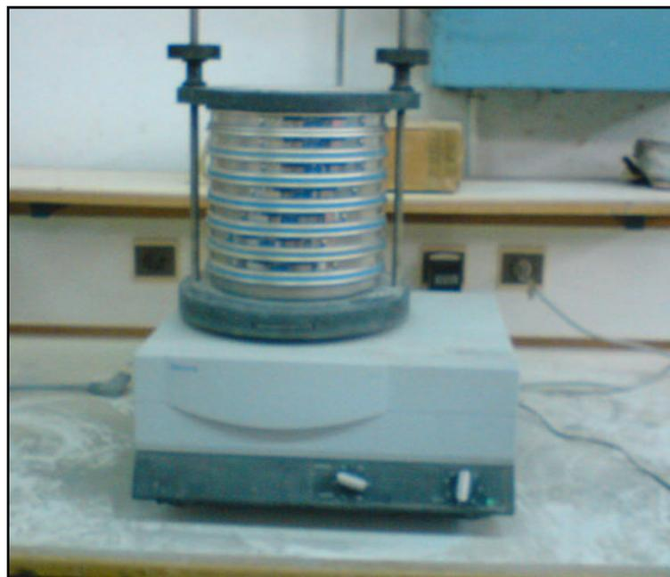
*Figure 3-1 : Série des tamis sur la tamiseuse.*
