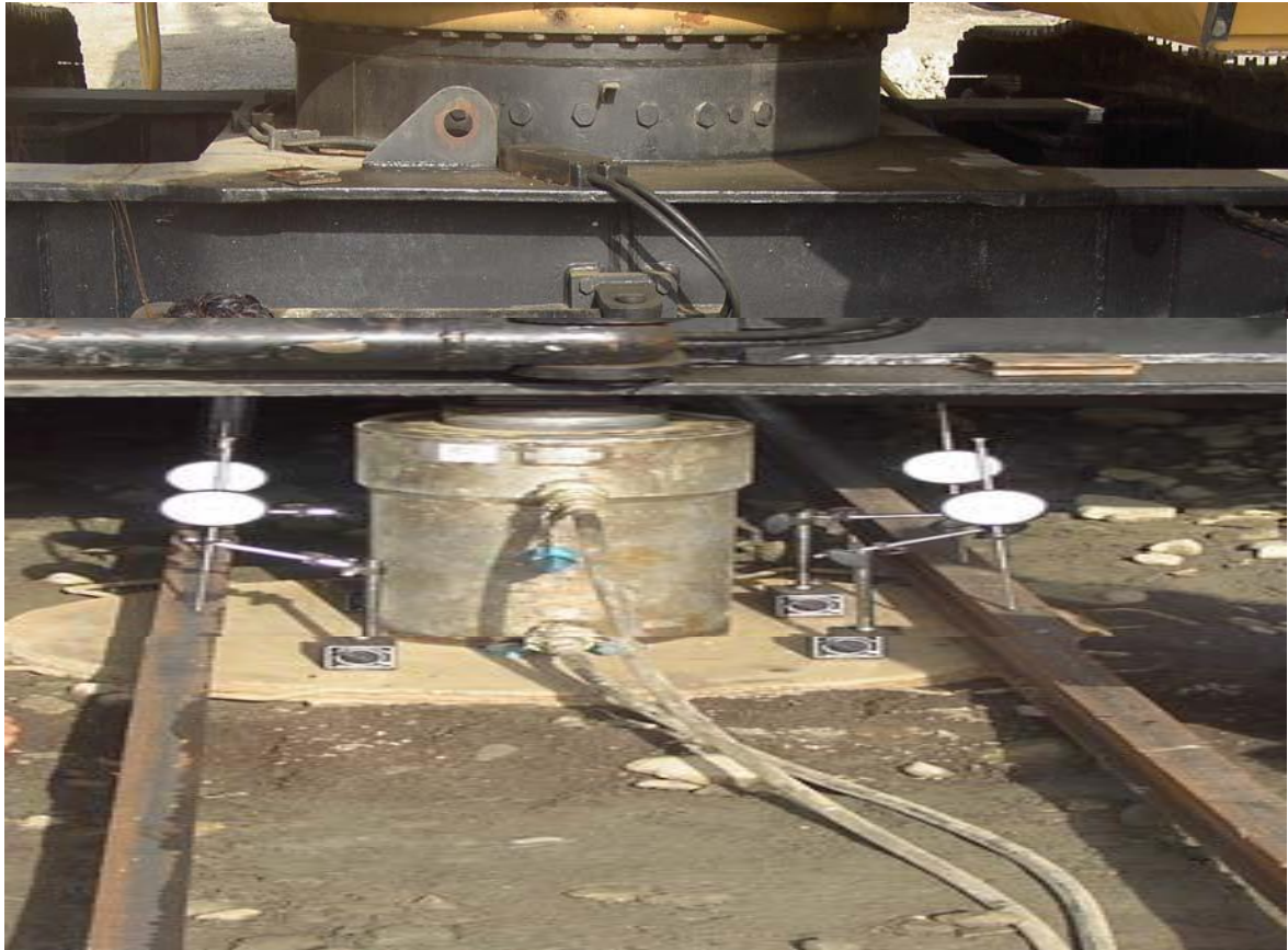
5.5 Essai de chargement à la plaque
