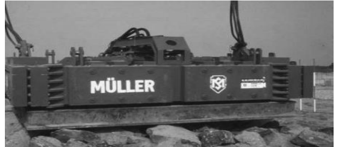
Fig.2.10 : Compactage par plaque vibrante lourde
