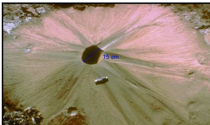
Fig 2.21 Cratère dû à une liquéfaction [F Benneker, 2004]
