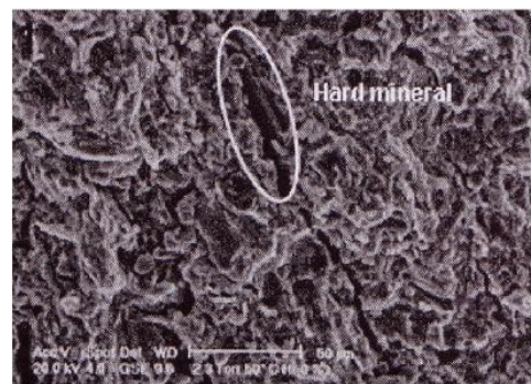
Figure. 1.9: Ouverture des fissures en proximité des matériaux rigides Montes et al, (wakim j, 2005).
