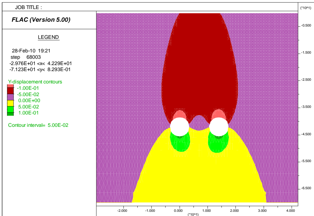
Figure V.16: Distribution des vecteurs déplacements pour une couverture \frac{t}{D}=5.5m .
