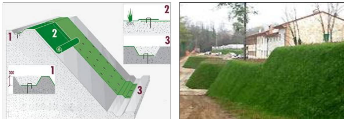
Figure 1.17 Les géogrilles anti-érosion.
