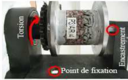
Figure IV-3 Dispositif d'essai torsion en laboratoire [M DIAKHATE 2007]
