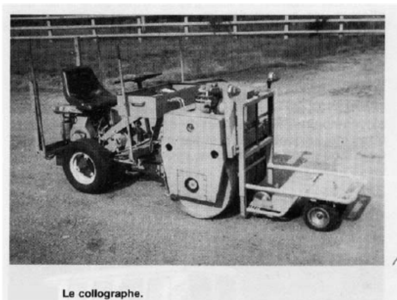
Figure IV-13: le collographe en position de mesure [J SIMONIN 2005]
