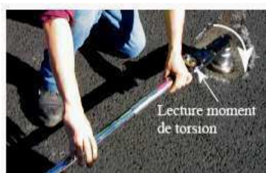
Figure IV-1-2 Dispositif d'essai de torsion sur chantier [M DIAKHATE 2007]
