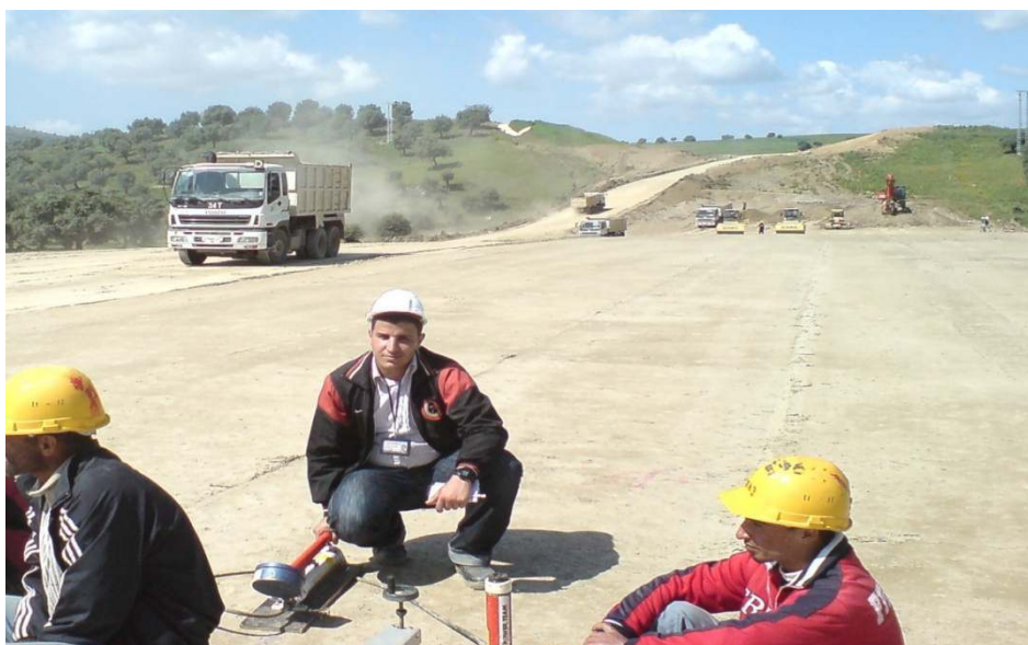
Photo A.8 : exécution d'essai de plaque, Harrouche, comp5
