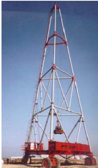
**Figure I.5** Engin utilisé pour la réalisation des plots ballastés (Document de Ménard Soltraitement®)
