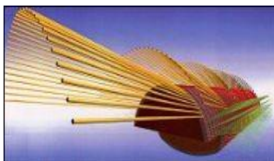
Figure I.12 : Voûte parapluie en 3D.
