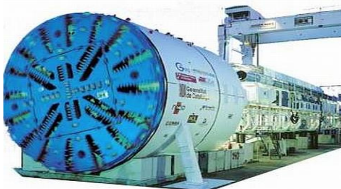
Figure I.5 : Tunnelier à bouclier.
