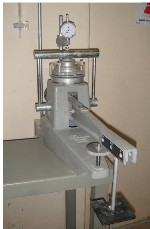
**Figure.2.6.** L'appareil œdométrique
