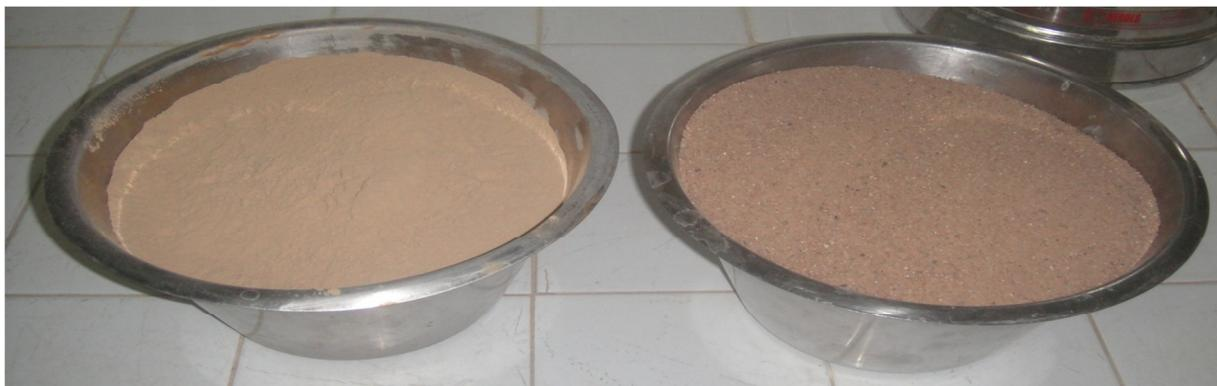
**Figure.2.8.** Les matériaux d'essai, à gauche : échantillon des particules fines et à droite échantillon de sable.
