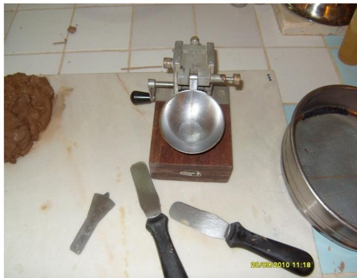
Figure. 2.2. L'appareillage d'essai de limite de liquidité.
