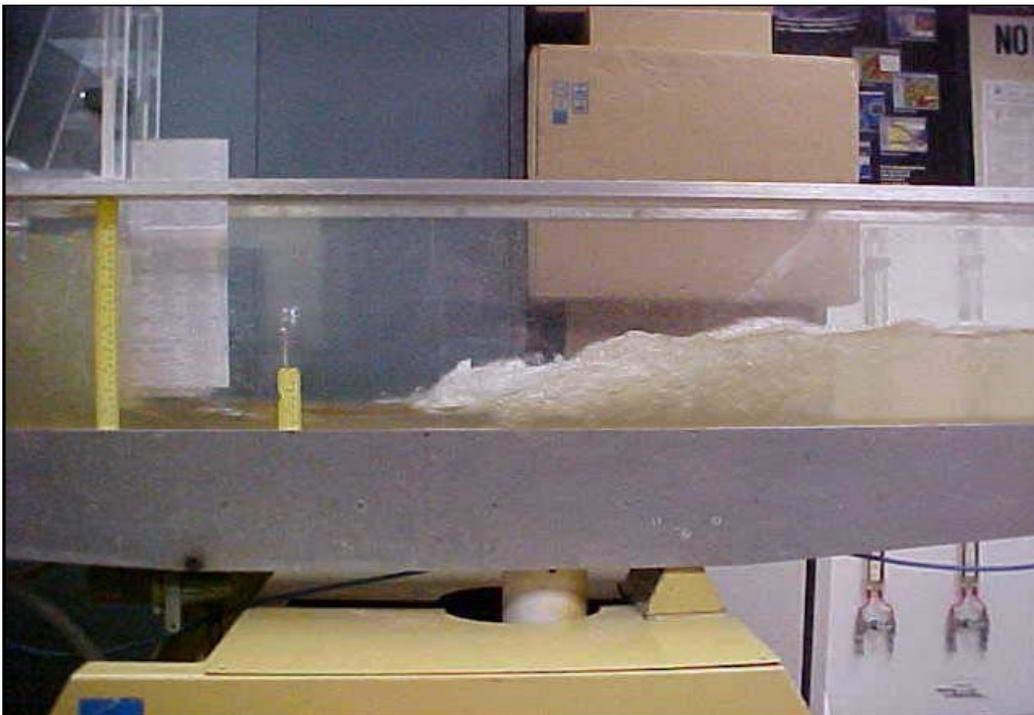
Figure I.10: simulation d'un ressaut [3].
