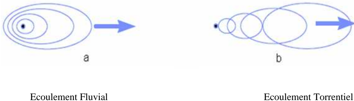
Figure 1.11: Le comportement des ondes selon les régimes d'écoulement
