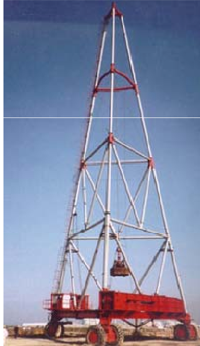
Figure III.5 Engin utilisé pour la réalisation des plots ballastés (Document de Ménard Soltraitement®)
