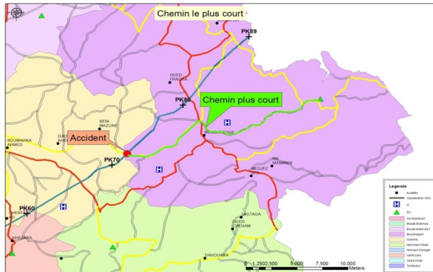
Fig. (III.11): Chemin le plus court avec Network Analyst de l'ArcGIS .
