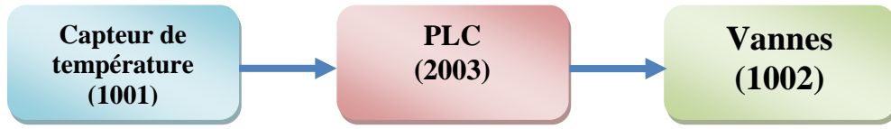
Figure 4.14. Schéma du SIS à deux capteurs
