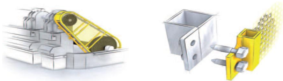
Figure III.5 : Exemples de protecteurs fixes constitués de grillage et de cornières, empêchant l'accès au mécanisme de transmission et munis de fixations imperdables (Blaise & al., 2012).
