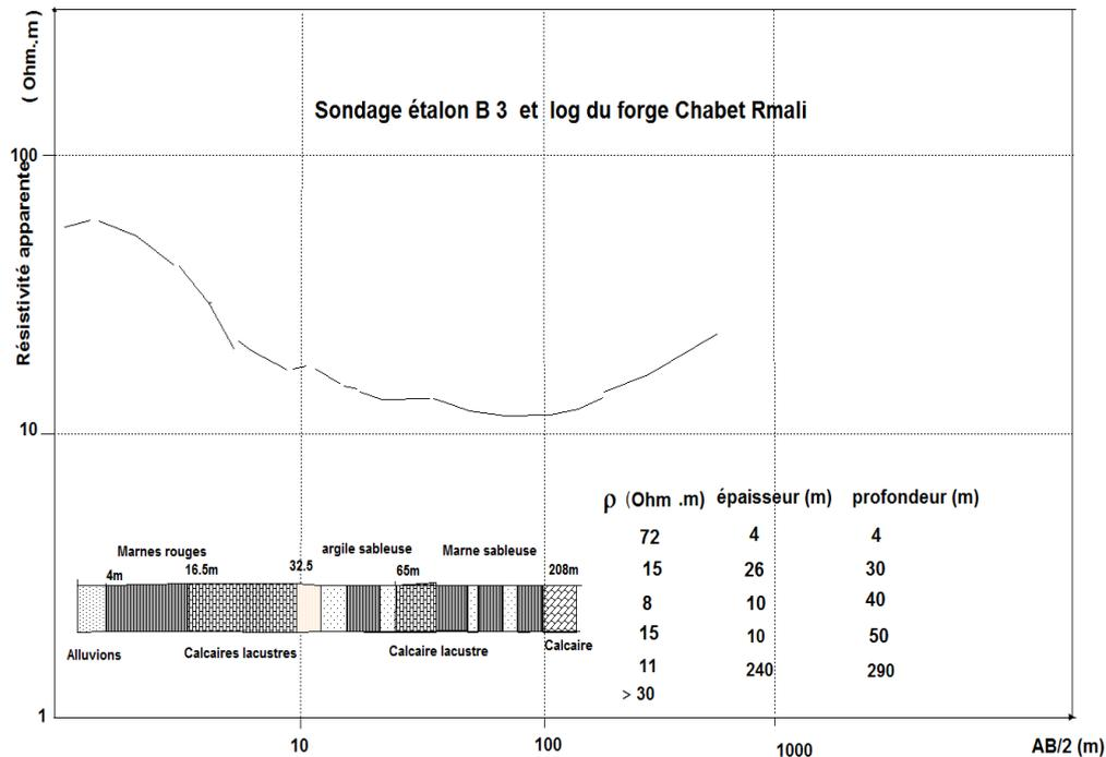
Figure 25. Courbe du sondage électrique d'étalonnage B3.
