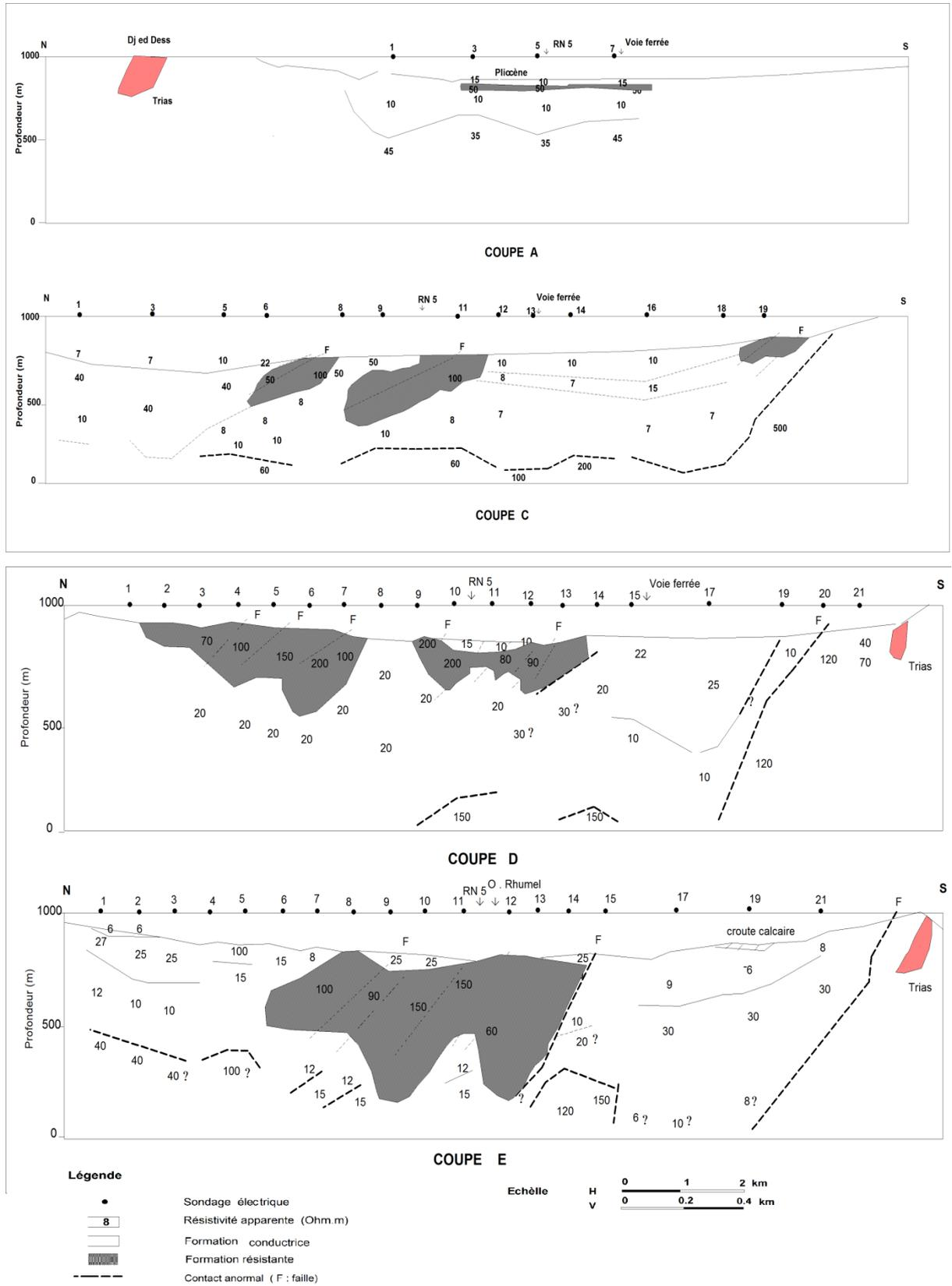
**Figure 29. Coupes géoélectriques A, C, D et E**
