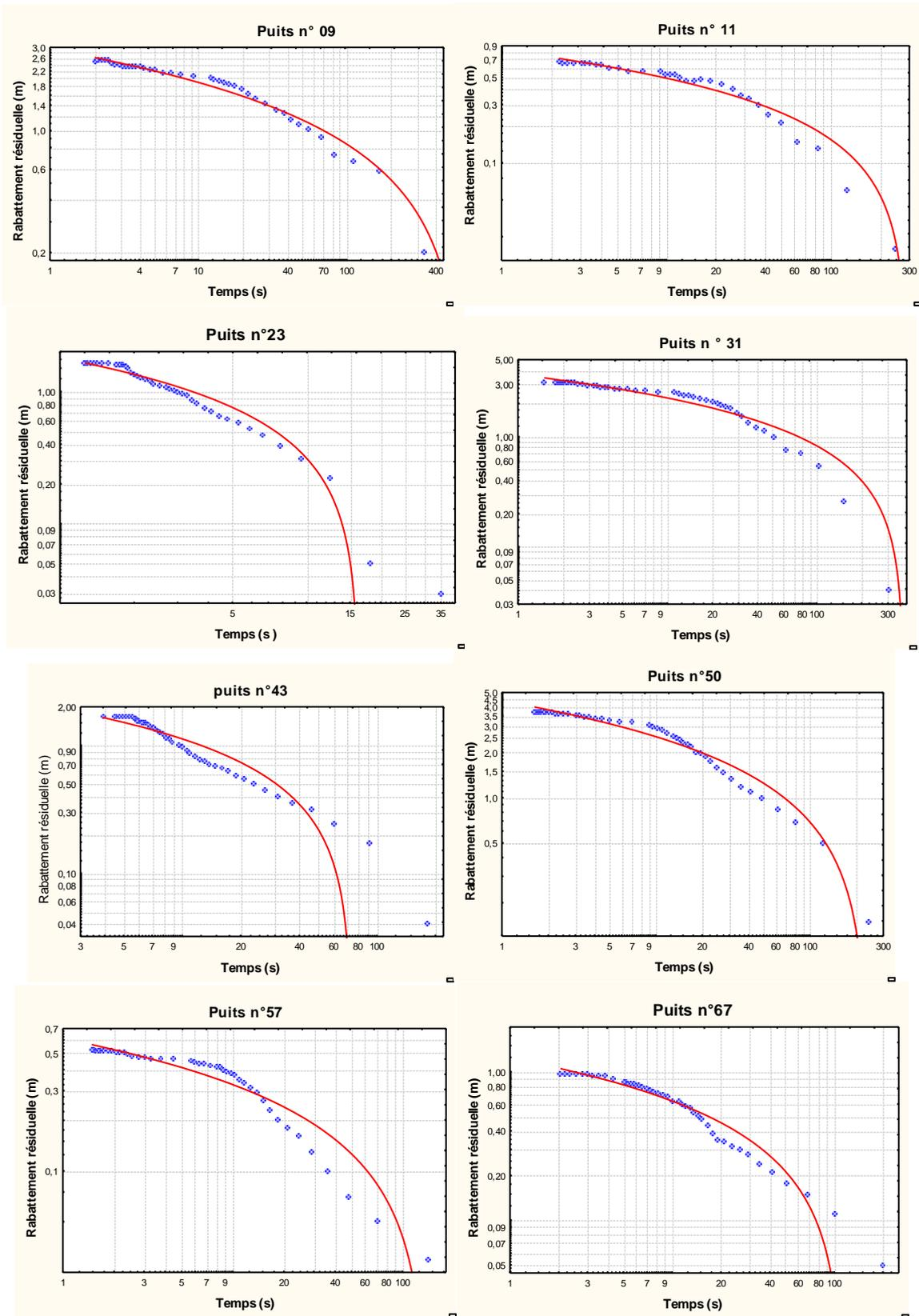
Figure 41. Essai de pompage – courbes de remontée
