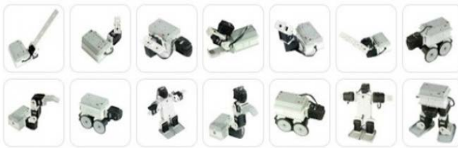
Figure.4.25-Robots Bioloid : avec un kit donné, il est possible de monter 14 modèles de robots différents présentés ci-contre et même d'en créer d'autres. Une fois le robot assemblé, il suffit de le programmer en langage C et de transférer le code compilé à l'aide d'un ordinateur.
