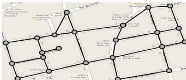
Figure.4.17-Représentation topologique : elle consiste à enregistrer les endroits et leurs relations les uns vis-à-vis des autres. La carte devient alors un graphe où les nœuds correspondent à des lieux et où les arcs correspondent au chemin entre elles. Ci-contre un quartier à Nancy (France) [Gla11].
