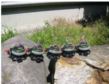
Figure.4.21-Swarm-bot : ensemble de S-bots attachés les uns aux autres dans une configuration donnée. Ici, les S-bots sont attachés en ligne ce qui leur permet de passer la faille se trouvant sur leur chemin. Un S-bot seul est incapable de réaliser une telle tâche.
