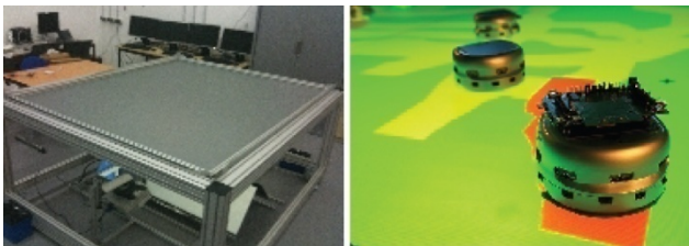
Figure.4.32-Nouveau dispositif d'essais : (a) table interactive pour robots, (b) mise en œuvre effective.
