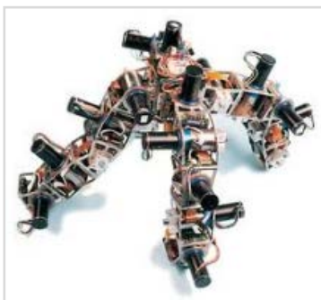
Figure.4.34-Montage polybot : composé de modules simples possédant leurs propres processeurs et qui sont de 2 types : les segments et les nœuds. Un segment est doté d'un degré de liberté, et de 2 ports de connexion. Deux faces opposées du module ont un plateau de connexion. Le degré de liberté du cube permet aux faces de pivoter et de ne plus être parallèles. Le segment est le module qui contient les capteurs pour la perception. Un nœud rigide mais possédant 6 ports de connexion. Il permet les structures parallèles, possède une puissance de calcul supérieure, abrite des réserves d'énergie, et crée des ponts entre les réseaux de communication.
