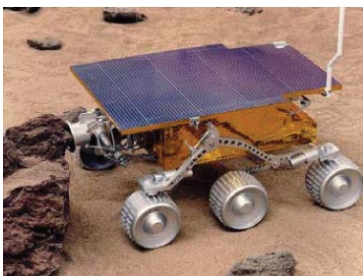
Figure.4.10-Sojourner : c'est un robot mobile semi-autonome, qui a été utilisé par la NASA dans sa mission vers Mars Pathfinder. Il est considéré comme étant le premier robot mobile qui à rouler sur cette planète.
