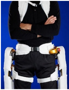
Figure.4.27-Exosquelette : NASA table sur une sorte de robot dit exosquelette (le XI), qui peut aider les astronautes à se déplacer et à s'entraîner pour maintenir leurs muscles en forme dans l'espace et peut même assister les personnes paraplégiques dans leurs mouvements au quotidien, sur terre.
