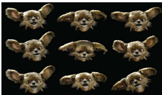
Figure.4.28-Robot Leonardo : c'est un robot compagnon développé par le Media Lab du MIT. Il est capable d'exprimer des émotions attendrissantes, capable de reconnaissance faciale, de suivi, et d'apprentissage sociale en étudiant son environnement et à travers ses interlocuteurs. Avec 69 degrés de liberté, dont 32 pour le visage, il est la peluche la plus expressive à nos jours.
