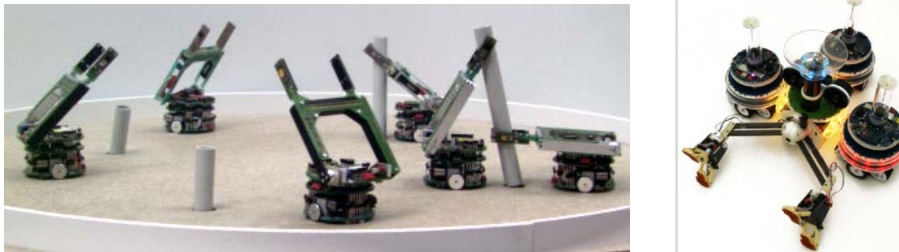
Figure.4.13-Tâches nécessitant la coopération de plusieurs robots : (à gauche) coopération de robots munis de pinces en synchronisant leurs activités dans le but de retirer un long bâton d'un trou, (à droite) 3 pieds-bots transportant un mains-bots tiré du projet SWARMANOID qui vise le développement et le contrôle d'un essaim hétérogène constitué de trois différents types de robots: les pieds-bots, qui se déplacent sur le sol et transportent des objets, yeux-bots, qui volent et ont la capacité de se fixer au plafond pour mieux visualiser, et les mains-bots, qui ont des bras et des pinces pour manipuler des objets et sont capables de grimper dans l'espace vertical.
