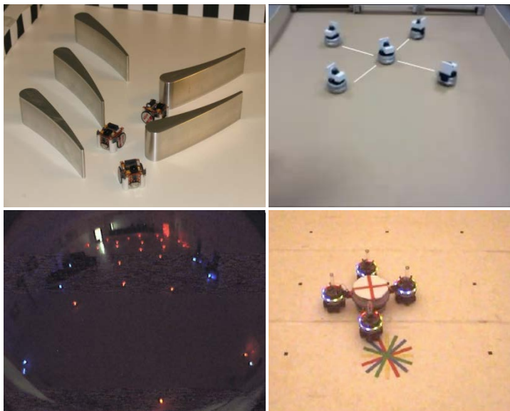
Figure.4.23-Comportement d'un essaim de robots : (en haut à gauche) couverture spatiale ; dans cette expérience, les robots doivent inspecter l'ensemble des pales d'une turbine le plus rapidement possible, (en bas à gauche) dispersion ; dans cette expérience, la densité des robots en un point de l'espace dépend de l'intensité lumineuse perçue en ce point, (en haut à droite) localisation de cibles ; dans cette expérience les robots coopèrent pour retrouver et encercler l'origine d'une source d'odeur, (en bas à droite) déplacement coordonné ; dans cette expérience les robots coordonnent leurs déplacements afin d'amener un objet vers une cible.
