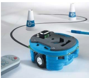
Figure.4.33-Robot autonome mobile Hemisson : la programmation du robot se fait via le port série. Le robot Hemisson est programmable par Visual Studio C++, Matlab ou tout autre programme qui peut accéder au port série.
