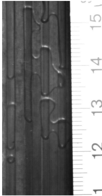
Figure 68. Régime d'écoulement annulaire.
