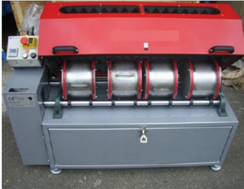
Figure 18: Machine d'essais Micro-Deval composée de 4 cylindres rotatifs
