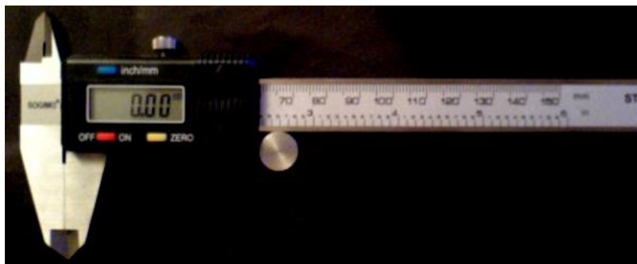
Fig. 46 : Pied à coulisse automatique utilisé dans les mesures des diamètres des zones d'inhibitions.
