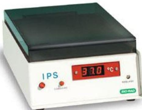
Figure 16. Incubateur sec de microplaques.
