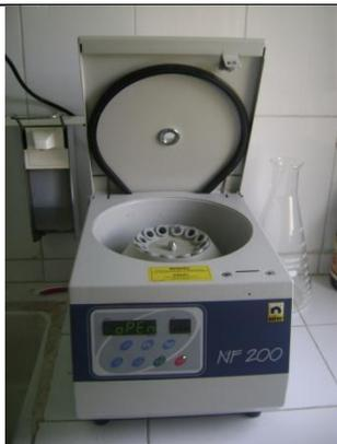
Figure 15. Centrifugeuse.
