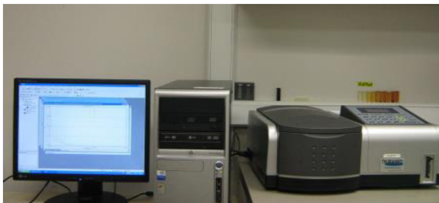
Fig. III.15: Spectrophotomètre T60 UV/Visible [Boud 2012]
