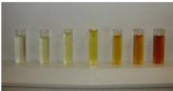
Fig. III.8 : Dégradation de liquide isolant au cours de vieillissement thermique (changement de couleur), photographie de colorimètre pour la mesure de l'indice couleur [SKMK 2005]
