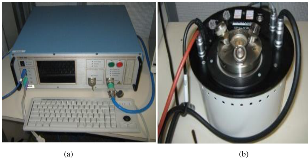
Fig. III.21 : Le dispositif de mesure IDA 200 TM avec Cellule type 2903 [Boud 2012]
