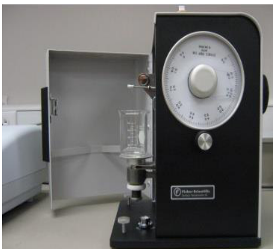
Fig. III.10 : Tensiomètre pour la mesure de la tension interfaciale.
