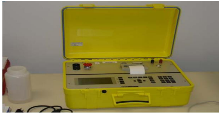
Fig. III.37 Appareil de mesure de tension de rétablissement au laboratoire ISOLIME [Boud 2011].
