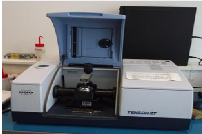
Fig. III.18 : photographie du dispositif FTIR (Laboratoire de chimie Laghouat)
