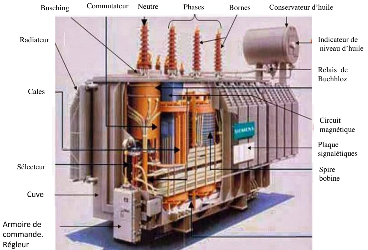
Fig. I.2. Constitution générale de transformateurs de puissance
