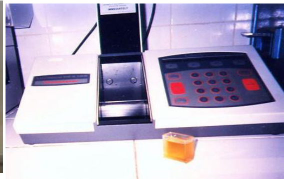
Fig. III.8 : Dégradation de liquide isolant au cours de vieillissement thermique (changement de couleur), photographie de colorimètre pour la mesure de l'indice couleur [SKMK 2005]
