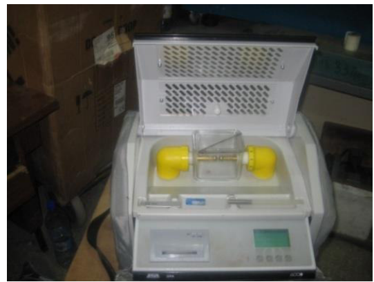
Fig. III.7 : Schéma de la cellule de mesure de la tension de claquage [Fof 2013, SKMK 2005]
