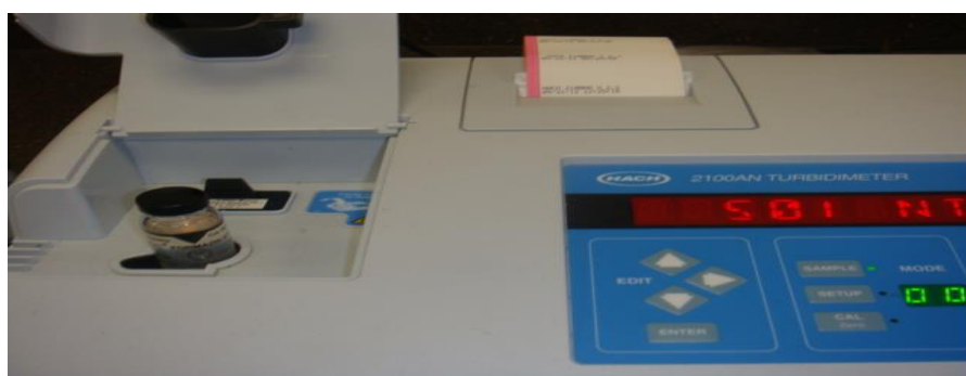
Fig. III.17 : Turbidimètre modèle 2100AN avec sa cellule de mesure.[Boud 2012]
