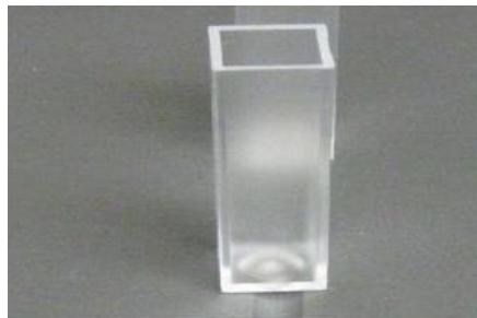
Fig. IV.1.7 Cellule ou cuve de mesure à usage unique de 2,5 ml d'huile
