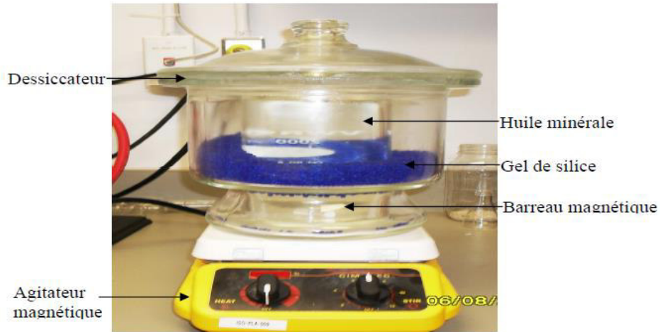
Fig. IV.1. Technique de déshumidification et dégazage de l'huile
