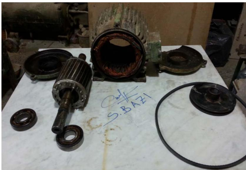
**Figure (I.1) :** Vu éclaté moteur asynchrone
