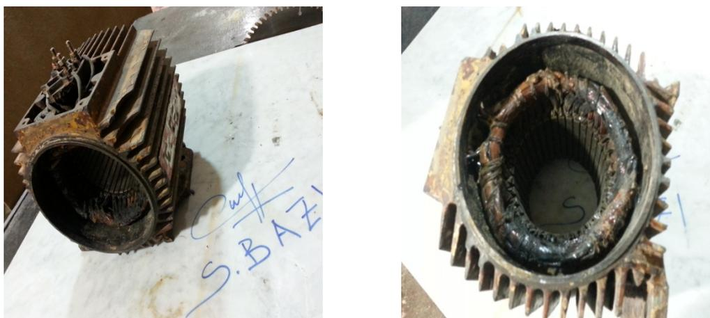
**Figure (I.7) : Stator d'un moteur asynchrone complètement grillé**
