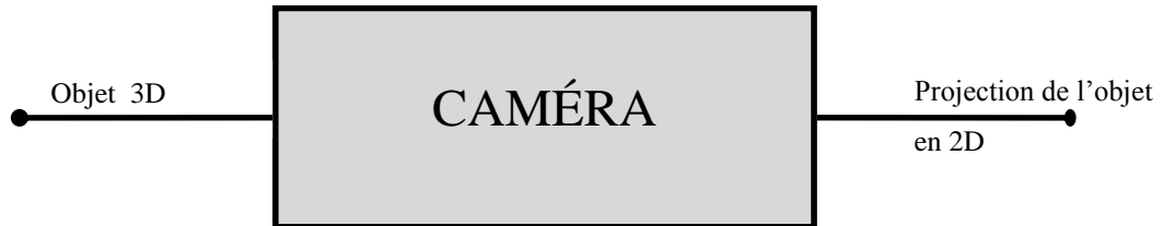
Figurel.9 : Calibrer une caméra consiste à trouver sa fonction de transfert
