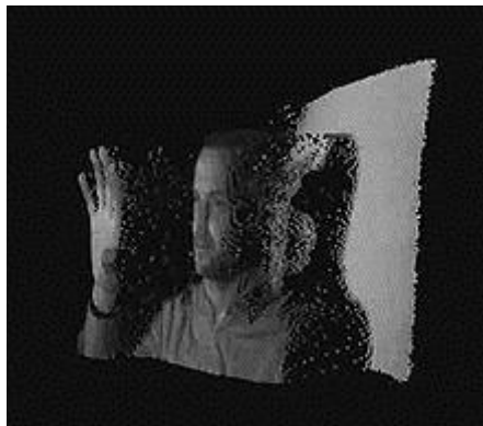
Figure II.4 : Image de distance d'un visage capturé avec une caméra temps de vol
