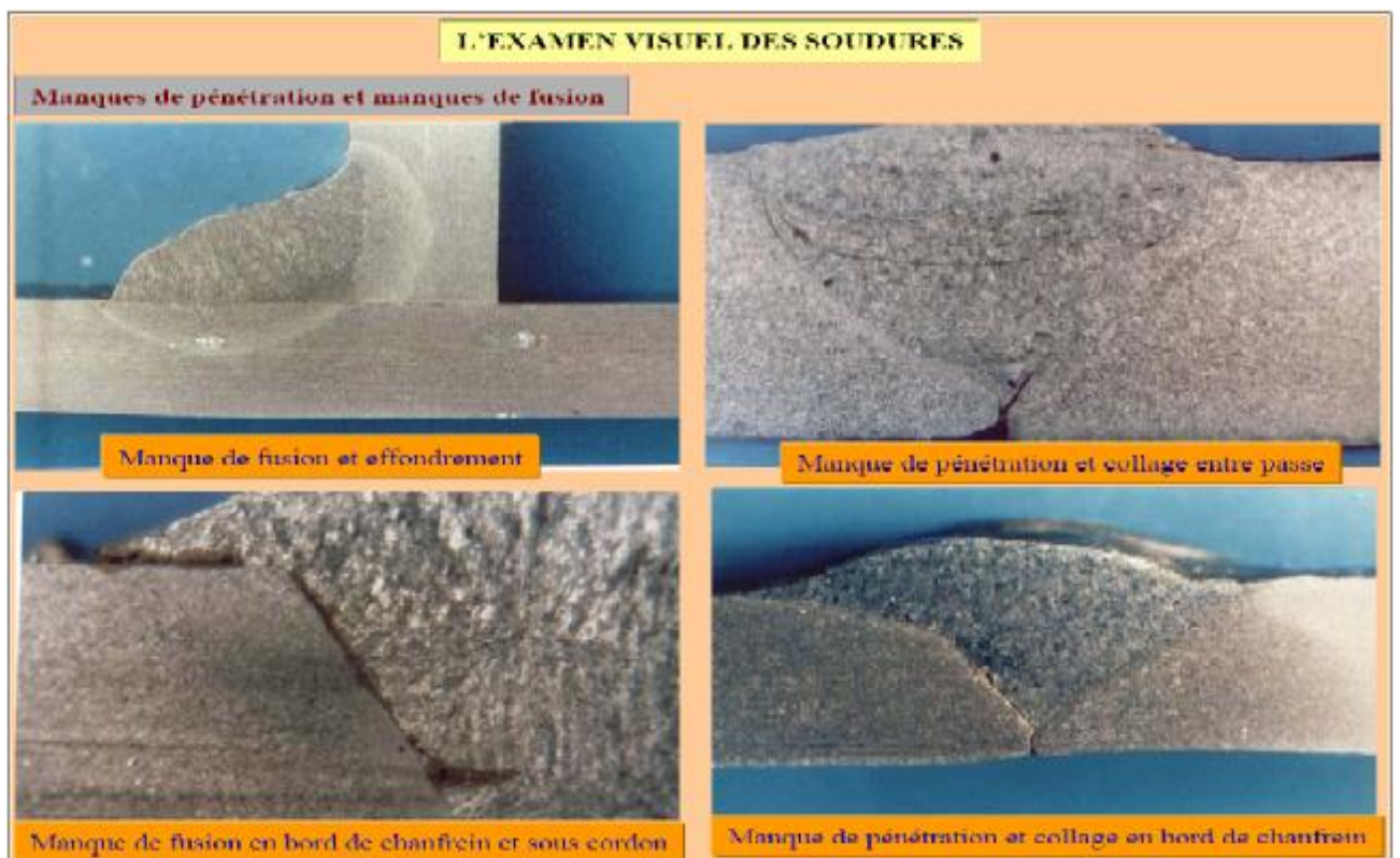
Figure V. 26 : Défauts de forme de soudure pouvant être décelés par examen visuel
