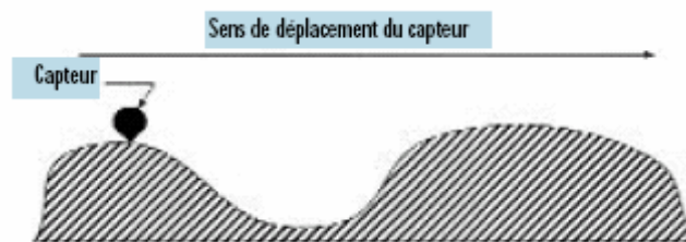
Figure II.1 : L'acquisition 3D mécanique par palpeur
