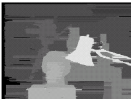
Figure II.32 : Exemple de résultat obtenu par la méthode de programmation dynamique. On remarque les traits horizontaux irréguliers entre les lignes.
