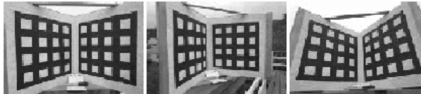
Figure II.20 : Une mire de calibration photographée sous plusieurs angles
