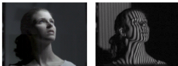
Figure II.6: Lumière structurée illuminant un visage
