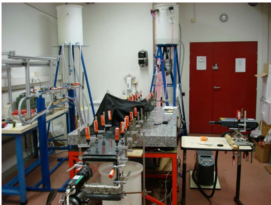
Figure 4.7 : Dispositif de montage de caméra et laser.
