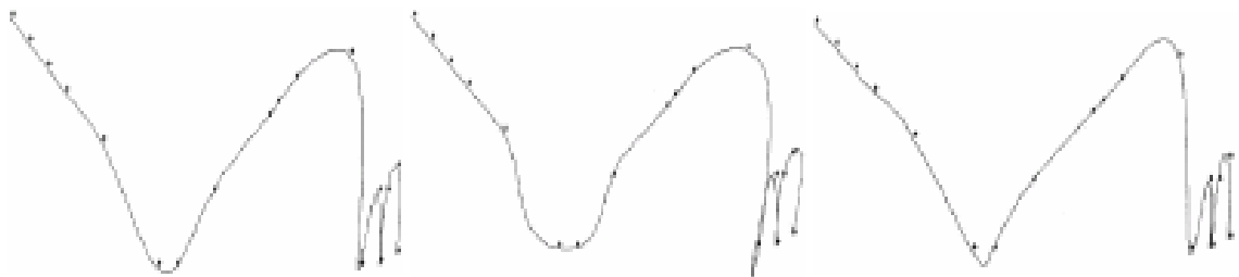
Figure I.11- Différentes techniques de construction d'une courbe à partir d'une séquence de points [2]
