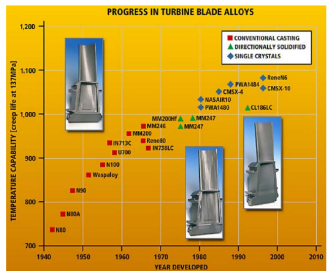
Figure II. 19- Graphe de progression de modèles d'ailettes de turbine [98]
