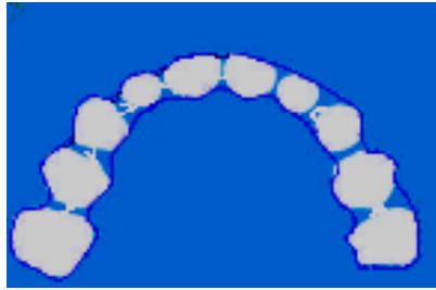
Figure II.29b- création du contour par courbe B-spline sous Solidworks.[42]
