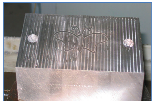
Figure I. 44– Résultat de l'usinage du profil papillon. [61]
