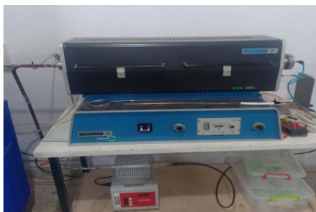
Figure 4.9 Photos des dispositifs du protocole expérimental élaboration et recuit thermique des films CZTS réalisés au Laboratoire LEA Batna 2.
