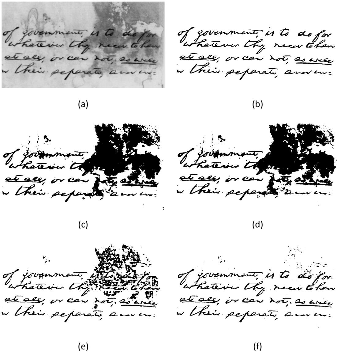
Figure 3. 3 Résultat de binarisation sur la base de données DIBCO 2009 [83]. (a) image original, (b) image de référence, (c) méthode d'OTSU, (d) méthode d'ISODATA, (e) méthode de Bernsen, (f) méthode de Niblack
