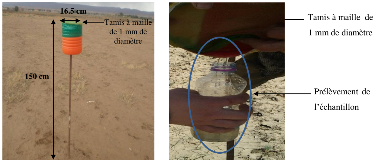
Figure II.6: Dispositif expérimental de captage des dépôts totaux d'ammoniac.
