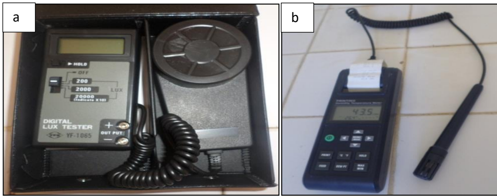
Figure II.32 : a). Luxmètre ; b). Hygromètre.
