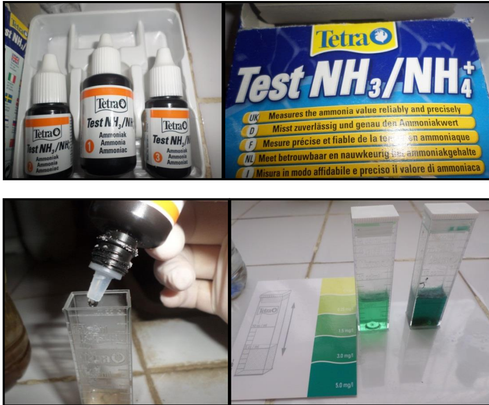
Figure II.8 : Photos représentant la méthode de dosage utilisé (Tetra test) pour déterminer les concentrations d'ammoniac dissous ( \text{NH}_3/\text{NH}_4^+ ) inférieur à 5 mg/l.
