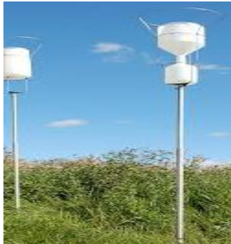
Figure I.7 : Collecteurs des dépôts totaux (bulk deposition).
