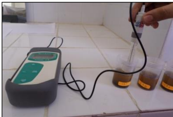
Figure II.10 : Le pH mètre manuelle utilisé pour la détermination du pH.
