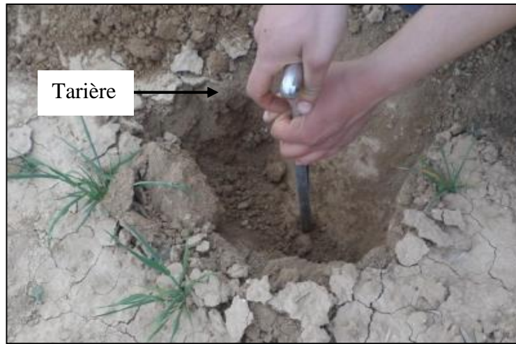
Figure II.13 : Photo représentant le prélèvement du sol par l'utilisation de la tarière.
