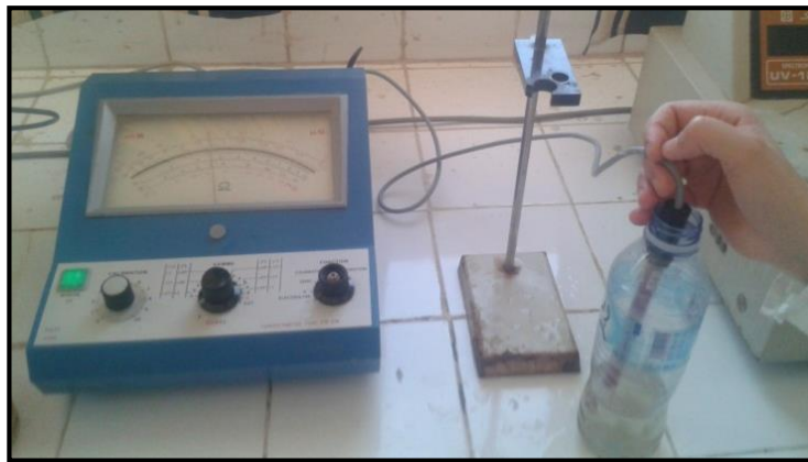
Figure II.11 : Conductimètre électrique de type CD6N
